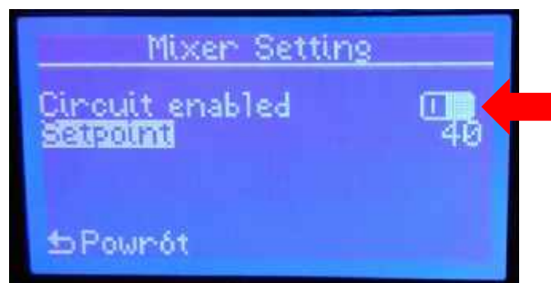
Circuit enabled nastavte na 1.
