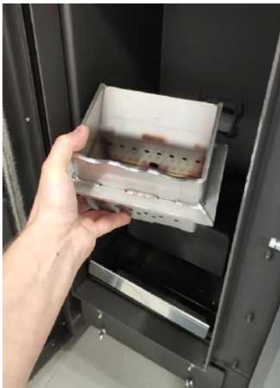
Čistenie roštu v kotly (verzia MINI)
