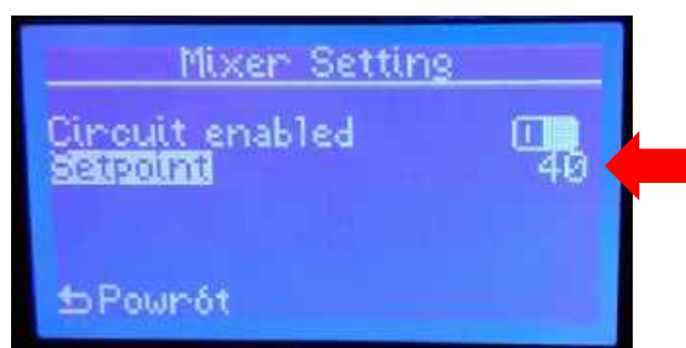
Setpoint: manuálny výber teploty za zmiešavačom.
